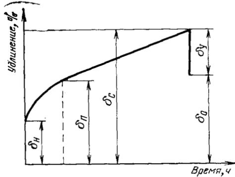
$\delta_n$ —удлинение при нагружении;  $\delta_p$ —полное (упругое + остаточное) удлинение на криволинейном участке);  $\delta_c$ —суммарное (упругое + остаточное) удлинение за время испытания;  $\delta_y$ —упругое удлинение;  $\delta_o$ —остаточное удлинение
